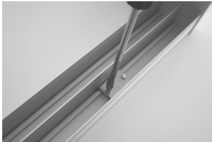
Monteer de RVS Montageplaat op het aluminium deel
